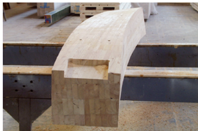
Randträger 45/45 mm zweifach gekrümmt
